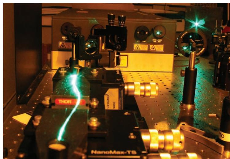
Faisceau laser émettant à la longueur d'onde de 500 nanomètres et guidé dans une microfibre optique, une fibre de verre effilée, 50 fois plus fine qu'un cheveu.
