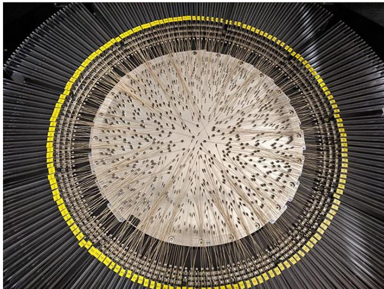
**Un champ WEAVE entièrement configuré, avec 700 des 950 fibres environ placées par deux robots (hors du cadre), sur place dans le télescope William Herschel.**
